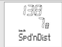
Как только Вы попадаете в меню Spd'nDist, пульсотахограф автоматически переходит на основную индикацию. Она показывает в средней строке текущую скорость. Нижняя строка указывает среднюю частоту пульса.
